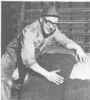
vor dem Aufsetzen des Formkastens: Giesser Josef Signer klopft den Modellhand an das Modell eines Dieselmotorkolbens.
